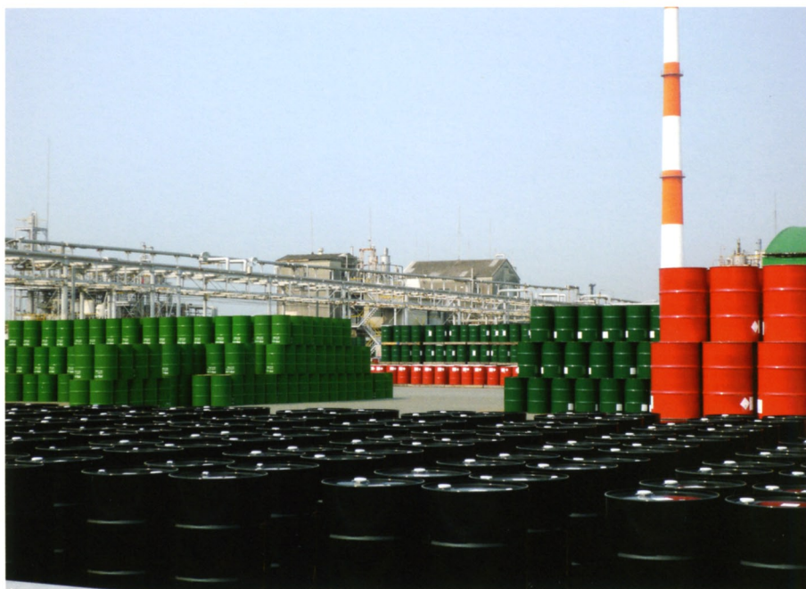
危険物屋外貯蔵所
